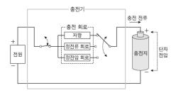
충전에 사용하는 충전기의 전원 전압은 충전지의 공칭 전압보다 높은 전압을 사용하고 충전지로 유입되는 전류를 저항으로 제한한다. 그러나 충전이 이루어지면서 충전지의 단자 전압이상승하여 유입되는 전류의 세기가 점점 줄어들게 된다. 그러므로 이를 막기 위해 충전기에는 충전 전류의 세기가 일정하도록하는 정전류 회로가 사용된다. 또한 정전압 회로를 사용하기도하는데, 이는 회로에 입력되는 전압이 변해도 출력되는 전압이일정하도록해 준다. 리튬 충전지를 충전할 경우, 정전류 회로를 사용하여 충전하다가 만충전 전압에이르면 정전압 회로로 전환
