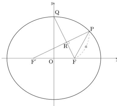
$\triangle F'RF \sim \triangle QOF$ 이 보이고, 삼각형 PRF가 직각삼각형인 사실에 집중하면, 여러 세부적인 길이  $\overline{RF}, \overline{RP}$ 를 구하고, 타원의 정의와 피타고라스 정리를 이용하여 a에 대한 방정식을 만들면, a의 길이를 구할 수 있음을 짐작할 수 있다.
