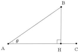
위 그림에서  $\overline{AB} \cdot \overline{AC} = |\overline{AH}| \times |\overline{AC}|$
