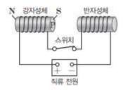
X. (가)에서 스위치를 열면 솔레노이드에 흐르는 전류에 의한 자기장이 없어지지만, 강자성체인 A는 외부 자기장을 제거하여도 자기화된 상태를 오래 유지한다. 따라서 A가 반자성체인 B를 자기화시키므로 A와 B 사이에는 서로 밀어내는 자기력이 작용한다.
