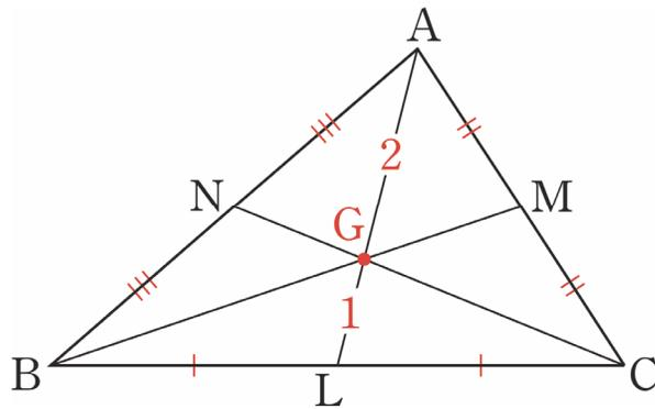
무게중심을 점  $G$ 라 하자.  $\overline{AG} : \overline{GL} = 2 : 1$ 이다. 마찬가지로  $\overline{BG} : \overline{GM} = 2 : 1$ ,  $\overline{CG} : \overline{GN} = 2 : 1$ 이다. 평가원에 기출을 풀기 위한 무게중심의 성질의 끝이다. 까먹지 말자.
