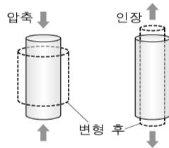
철재만으로 제작된 원기둥 A와 콘크리트만으로 제작된 원기둥 B에 힘을 가하며 변형을 관찰하였다. A와 B의 윗면과 아랫면에 수직인 방향으로 압축력을 가했더니 높이가 줄어들면서 지름은 늘어났다. 또, A의 윗면과 아랫면에 수직인 방향으로 인장력을 가했더니 높이가 늘어나면서 지름이 줄어들었다. 이때 지름의 변화량의 절댓값을 높이의 변화량의 절댓값으로 나누어 포아송 비를 구하였더니, 일반적으로 알려진 철재와 콘크리트의 포아송 비를 구하였다. 그리고 A와 B의 포아송 비는 변형 정도에 상관없이 그 값이 변하지 않았다. (단, 힘을 가하기 전 A의 지름과 높이는 B와 동일하다.)
