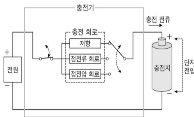
충전에 사용하는 충전기의 전원 전압은 충전지의 공칭 전압보다 높은 전압을 사용하고 충전지로 유입되는 전류를 저항으로 제한한다. 그러나 충전이 이루어지면서 충전지의 단자 전압이 상승하여 유입되는 전류의 세기가 점점 줄어들게 된다. 그러므로 이를 막기 위해 충전기에는 충전 전류의 세기가 일정하도록 하는 정전류 회로가 사용된다. 또한 정전압 회로를 사용하기도 하는데, 이는 회로에 입력되는 전압이 변해도 출력되는 전압이 일정하도록 해 준다. 리튬 충전지를 충전할 경우, 정전류 회로를 사용하여 충전하다가 만충전 전압에 이르면 정전압 회로로 전환하여 정해진 시간 동안 충전지에 공급하는 전압을 일정하게 유지함으로써 충전지 내부에 리튬 이온이 고르게 분포될 수 있게 한다.
