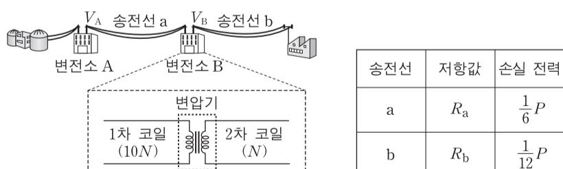
$R_a : R_b$  와  $V_A : V_B$  는? (단, 변전소 A, B에서의 에너지 손실은 무시한다.) [3점]
