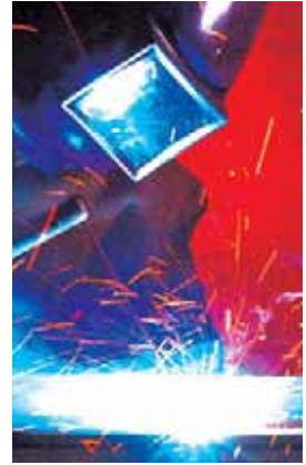
그림 Ⅲ-65 산소 아세틸렌 불꽃은 높은 열을 내므로 철 제품 등의 용접에 사용한다.
